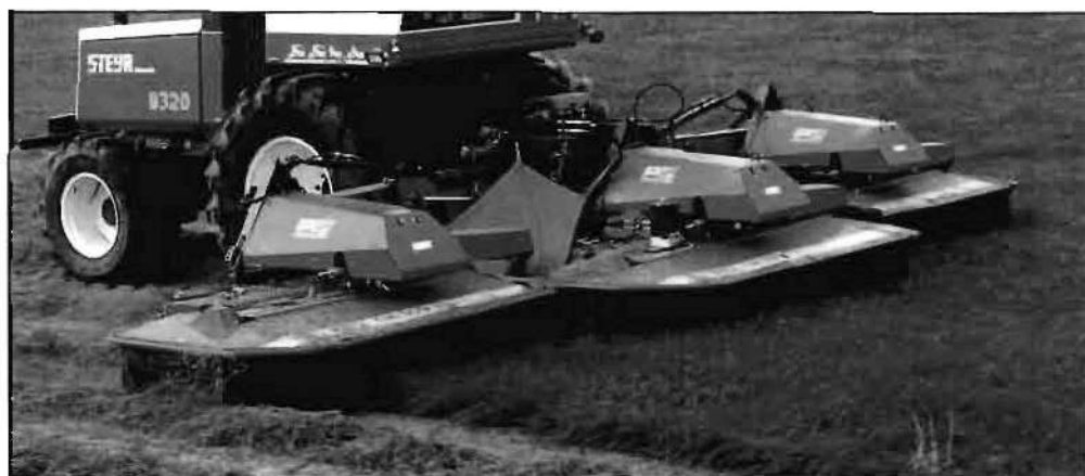
Fig. 2. Las segadoras de tambores PZ (Greenland) pueden ser dispuestas en tandem para abarcar anchuras de hast 8,7 m.
