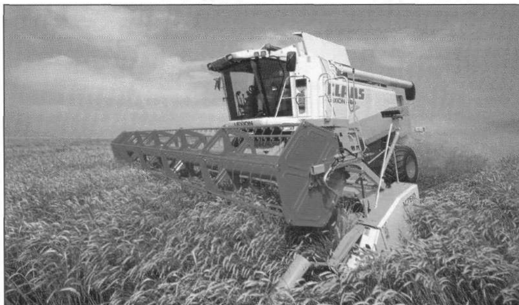
Claas ha renovado sus máquinas Lexion añadiéndoles el apellido Evolution. Una de sus mejoras consiste en la adición de un cilindro batidor de dedos sobre los sacudidores (Multi Sistema Separador).
