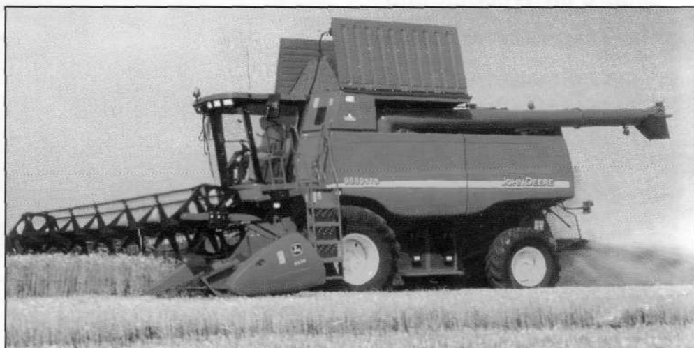
La 9880STS de John Deere es la mayor cosechadora del mercado hasta el momento: 465CV, tolva de 11.000 l y separación rotativa con un solo rotor.
