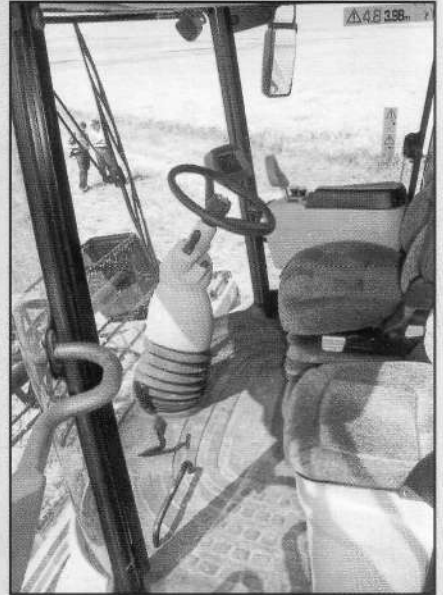
La cabina posee una gran visibilidad sobre el cultivo, es confortable y poco ruidosa. Se varía la posición del asiento, volante y consola lateral. El aire acondicionado está bien resuelto y en los huecos superiores de la cabina se pueden instalar los controles para "agricultura de precisión".
