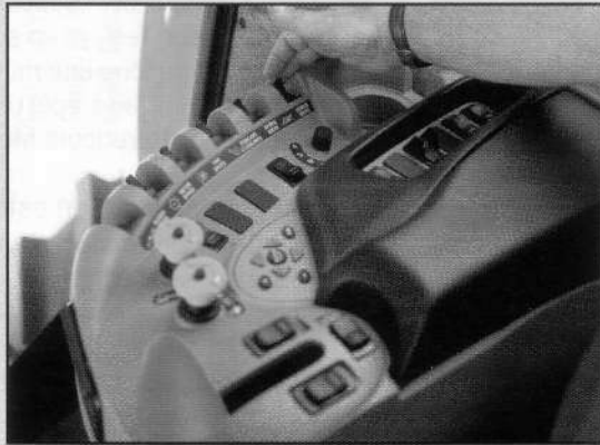
La consola, a la derecha del conductor, tiene varias posiciones regulables, y agrupa todos los controles. Debajo del reposabrazos abatible se ha colocado un teclado numérico.
