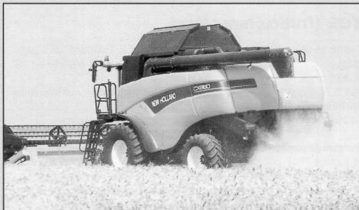
El picador integrado no sobresale de la parte posterior de la cosechadora y maneja a la vez la paja y los restos de granzas y tamo que son impulsados desde las cribas.
