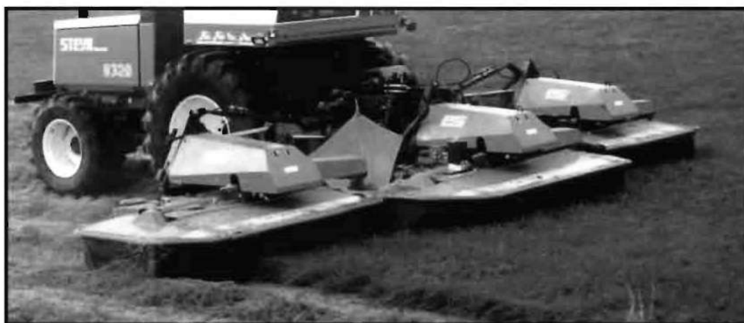
Segadora CM 300 de PZ-Greenland. Anchura de trabajo 8,70 m.
