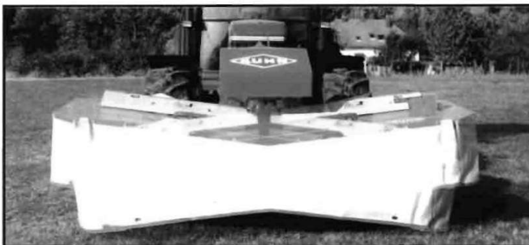
Sistema de flotación de segadora acondicionadora Kuhn.
