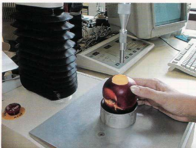
Realización de Magness Taylor con texturómetro de sobremesa, sobre nectarina Fantasia .
