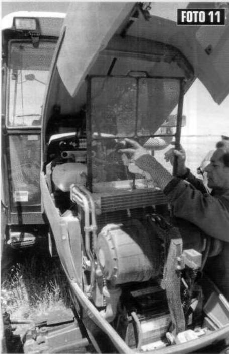
Foto 10. Acceso fácil a los puntos de mantenimiento del motor.
