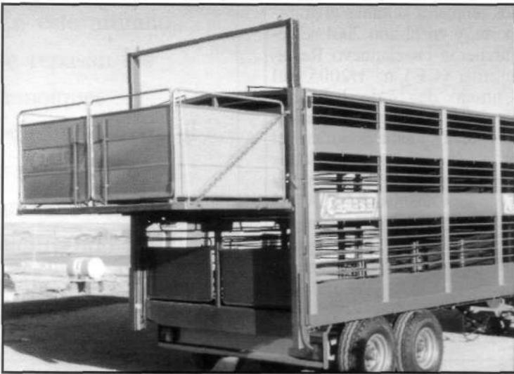
Figura 5. Elevador hidráulico para carga de pisos superiores.
