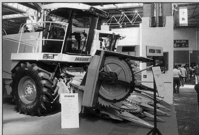
Fig. 4. Cabezal de discos rotativos RU-450 para picado de maíz, de Claas.
