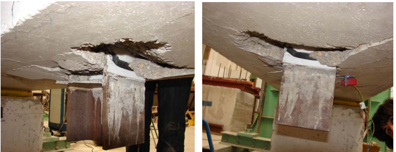
Fig.12 Fotografías de la rotura del pilar con teflón
