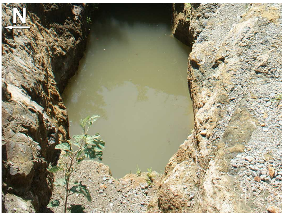
Figura 5: Laboreo minero en propilitas auríferas del campo mineral Aguas Claras.
