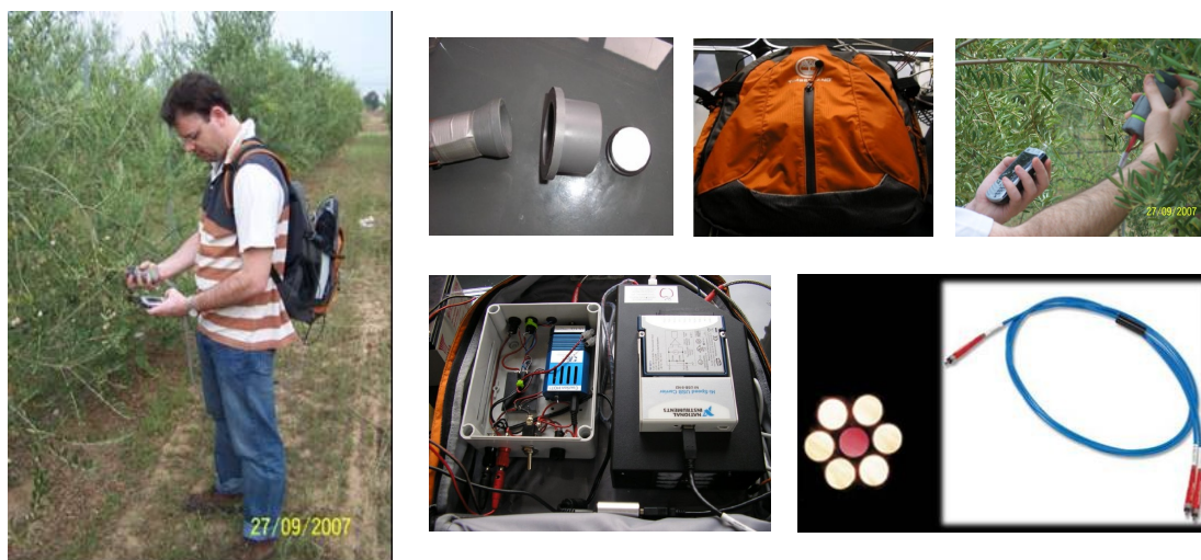
Figura 1. Distintos componentes que integran el espectrofotómetro NIRS - Hamamatsu de campo, y recogida de espectros sobre las aceitunas en el árbol:
