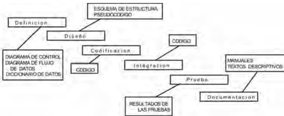
Fig. 3 Productos que se generan en cada una de las etapas de producción de software (según el modelo de la cascada), basado en [Grady, 1990]
