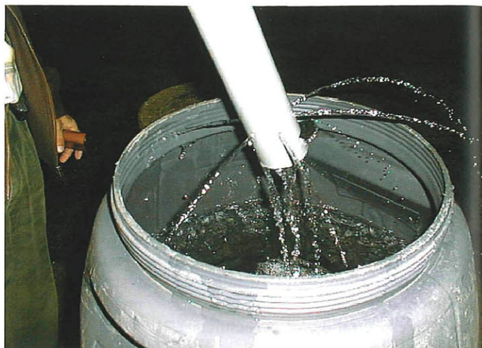
2.- Dispositivo utilizado para obtener una muestra del perfil vertical de un fermentador.
