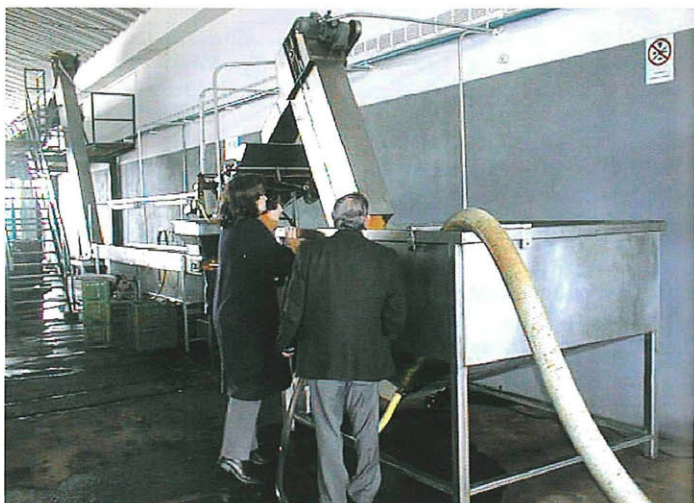
4.- Tolva de descarga de las olivas desde el fermentador a través de un conducto de bombeo.
