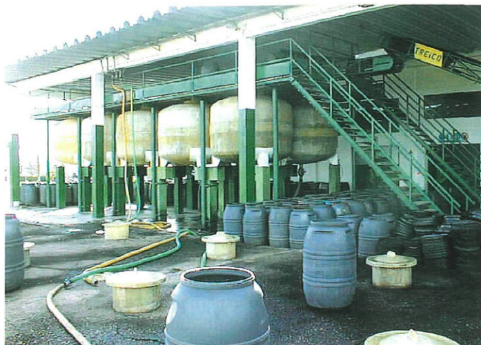
1.- Vista de los depósitos aéreos de salmuera, de los fermentadores (enterrados) y bidones plásticos para la recogida de muestras. Empresa AGRODELTA (Portugal).
