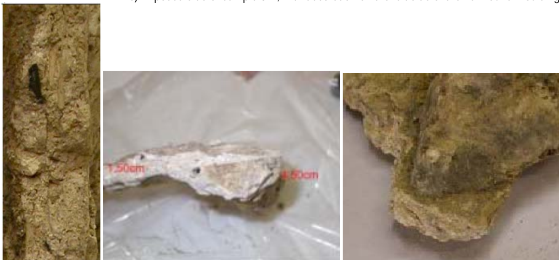
Fig. 4: a) Unión enlucido-moldura, presencia de formaciones laminares y nódulo de cenizas. b) Vista de la sección; c) Macrofotografía de la superposición de la media caña sobre el enlucido.
