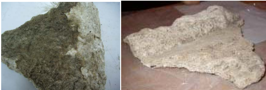
Fig. 3: a) Cara posterior de la muestra, presencia de la capa terrosa en contacto con la fábrica de ladrillo. b) Cara vista de la muestra 3 A con media caña decorada a la izquierda de la muestra.
