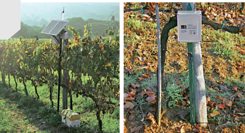
Sopra. Applicazione della rete WSN per il monitoraggio del vigneto dell'azienda agricola Montepaldi (San Casciano Val di Pesa, FI).
