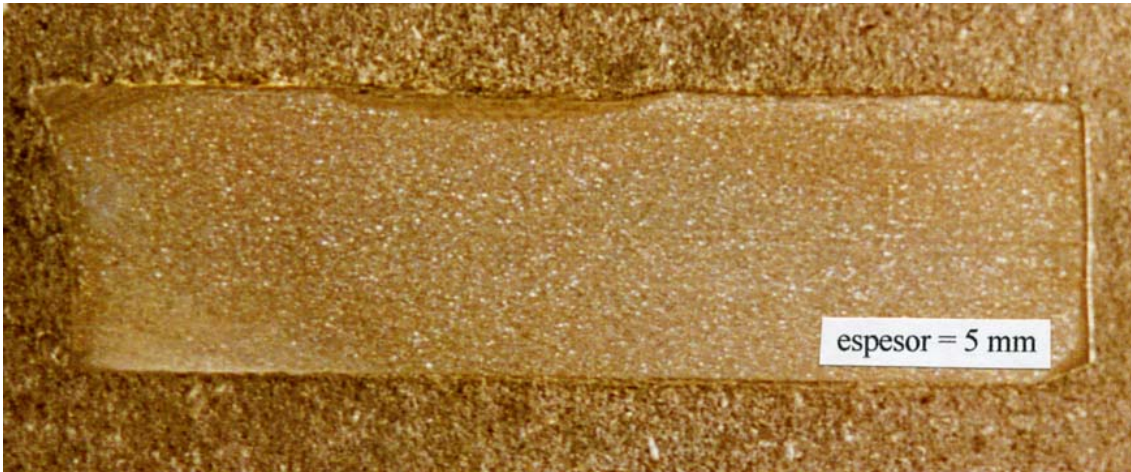
Figura 6.3.7. Sección transversal de la probeta resultado del temple superficial con P = 1480 \text{ W} y r_C = 3 \text{ mm} .
