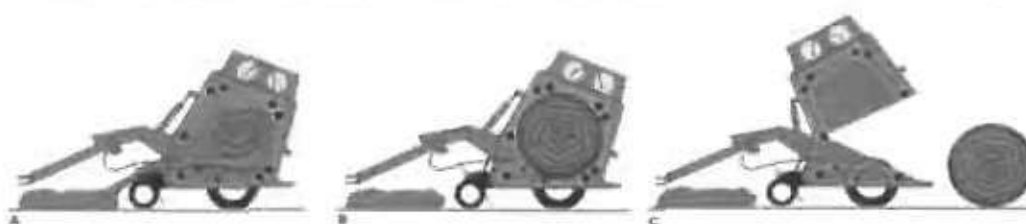
Figura 4. Esquema de la formación de la paca en las rotoempacadoras de cámara fija.
