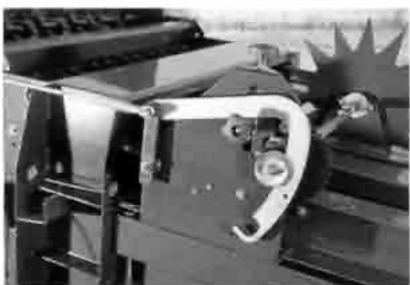
Foto 6. Rampa de descarga con dispositivo para pesaje. Fuente: New Holland.
