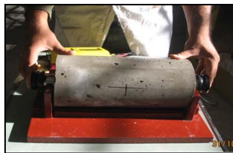
Figura 6: Medida de la velocidad ultrasónica.
