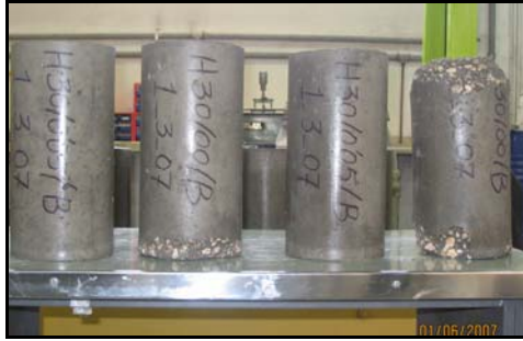
Figura 2: Probetas H30/00/B y H30/0,05/B al finalizar el ensayo de hielo-deshielo
