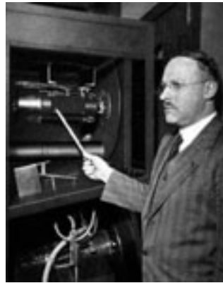
Figura 30. Fotografía de Harry M. Stoller; uno de los colaboradores de Ives, señalando con una regla el motor de un disco de Nipkow ubicado en el interior de un «picture-phone». Este equipo, presentado con carácter experimental en Nueva York, en 1930, tiene el mérito de ser el primer videoteléfono de la historia. Fuente: Ives-1930.
