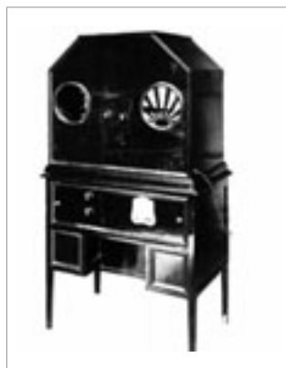
Figura 10. Televisor «Modelo C» de Baird, fabricado en 1928. La pantalla se encuentra situada en su lado izquierdo y el receptor de sonido se encuentra ubicado en la parte inferior. El mueble del televisor, como puede apreciarse, tiene una forma que permite acomodar en su interior el disco de Nipkow. Fuente: Baird Laboratory Glass Lecture Slides, Baird-1930.
