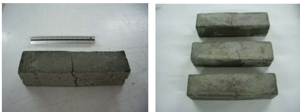
Figura 4.- Rotura de probetas de mortero cemento-caucho después de un ensayo a flexión.
