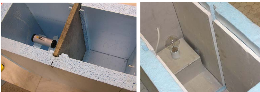
Figura 2.- Equipo para el ensayo de reducción de la presión sonora, aislamiento térmico y atenuación a impacto. Para el aislamiento térmico se recubre interiormente de placas de yeso laminado.
