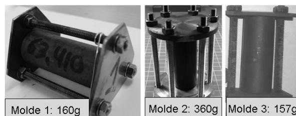
**Figura 1.** Pesos de los moldes (peso del molde cilíndrico: 63,41g)
