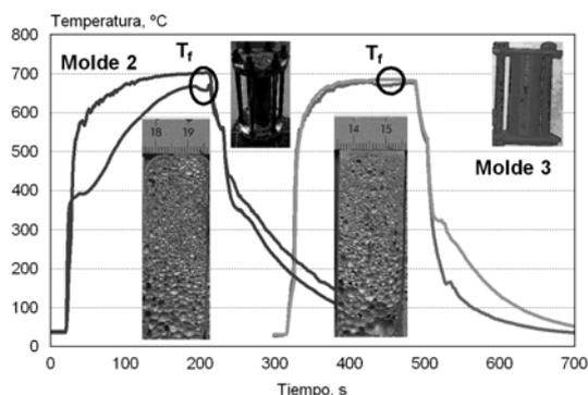
**Figura 5.** Curvas de calentamiento de los moldes 2 y 3 con dos termopares, y estructura de la espuma obtenida con densidades de 0,69 g/cm<sup>3</sup> con el molde 2 y 0,66g/cm<sup>3</sup> con el molde 3.
