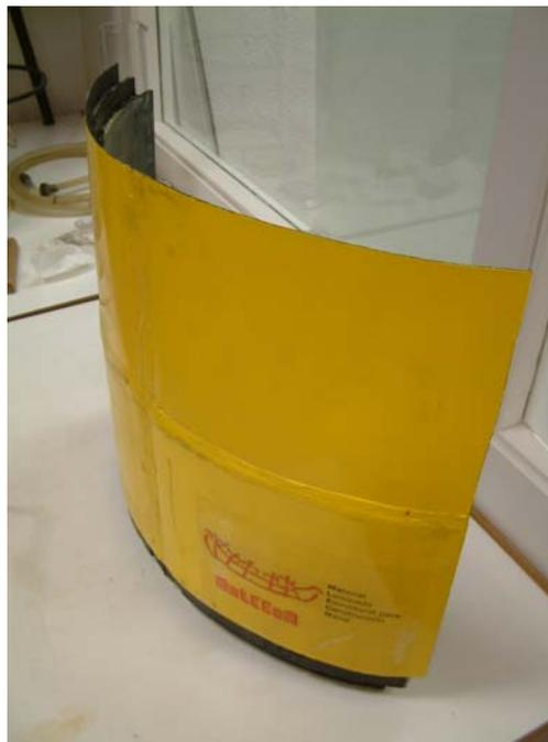
Figura 2. "Panel curvo compuesto fabricado con Malecon®"
