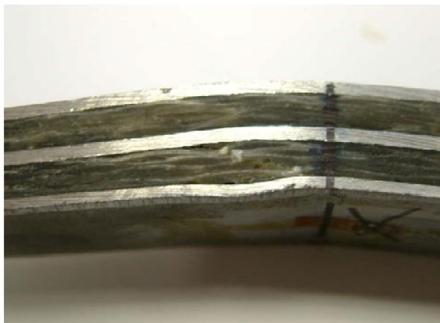
Figura 4. "Fallo por pandeo local de un laminado híbrido fibra-metal"
