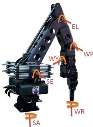
Figura 2: Manipulador Hidráulico de Kraft Telerobotics Inc con sus grados de libertad.
