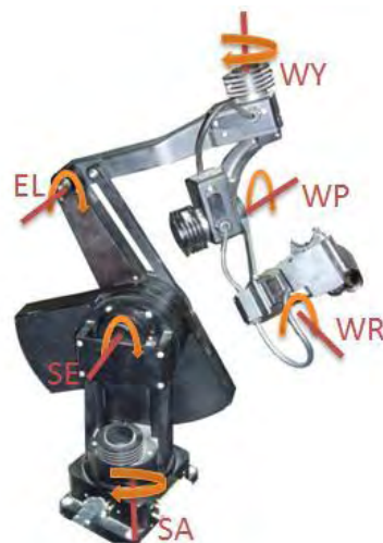
Figura 3: Maestro con reflexión de fuerzas de Kraft Telerobotics Inc.
