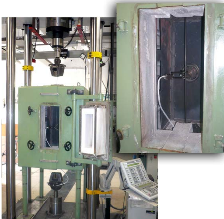
Fig. 1. Dispositivo experimental utilizado en este trabajo: máquina de ensayos mecánicos, horno y extensómetro para altas temperaturas.
