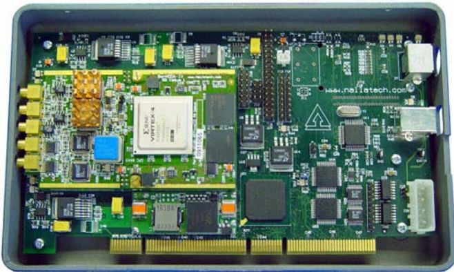
Fig. 4. XtremeDSP Platform (©Xilinx).
