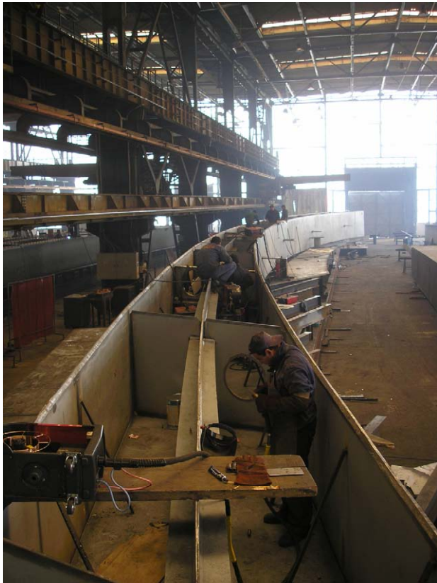
Fig. 13. Construcción en taller de arco (izquierda) y vigas longitudinales (derecha).
