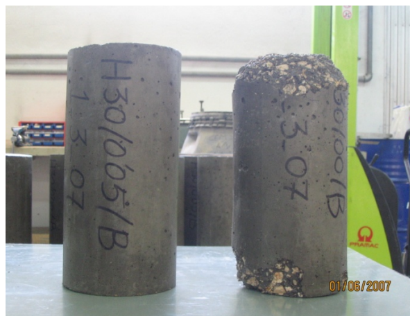
Figura 2: Probetas H30-0,05-B y H30-00-B después del ensayo de hielo/deshielo.
