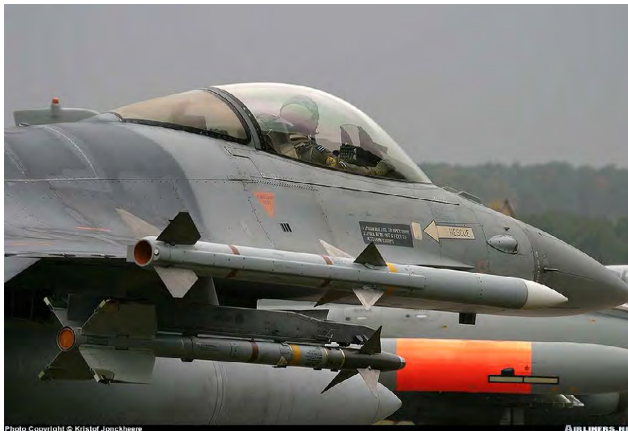
Figura 7.3: Soportado S01 : misil colgado de pílón (foto: F16).
