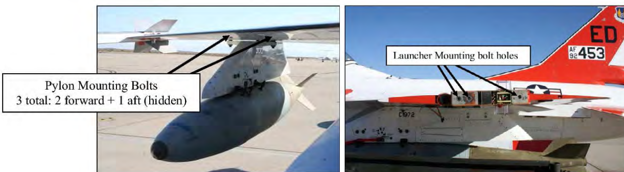
Figura 1.2: Figura extraída de [Bro07]: Estudio del efecto del par de apriete de las sujeciones pílón/ala y misil/lanzador en la amplitud de las oscilaciones LCOs.
