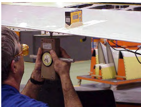
Figura 1.6: Arriba: Procedimiento para medida del freeplay en un timón de profundidad del avión Airbus A320. Medio: Instrumentación para medida. Abajo: operario introduciendo carga vertical de 30 daN y midiendo desplazamiento del borde de salida del timón de profundidad.
