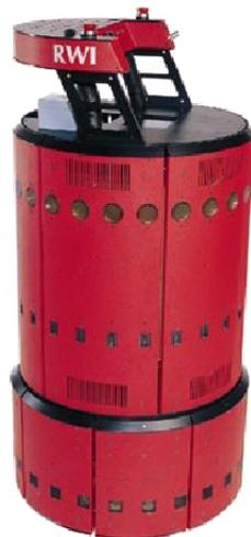
Figura C.1: Plataforma móvil B21r de iRobot
