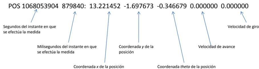
Figura 3.6: Línea de fichero correspondiente a datos de odometría
