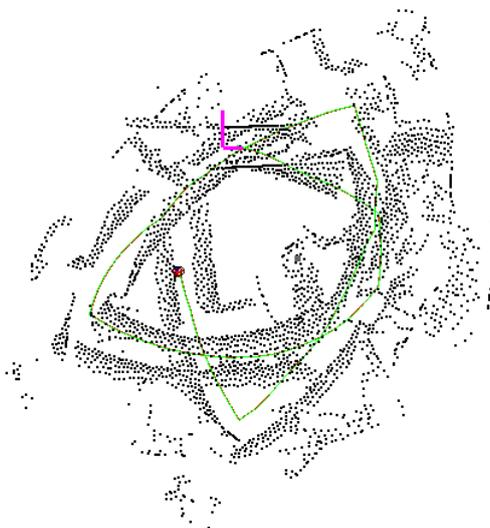
Figura 4.10: Mapa de Intel basado únicamente en datos de odometría
