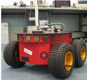
Figura C.2: Plataforma móvil Pioneer P3-AT
