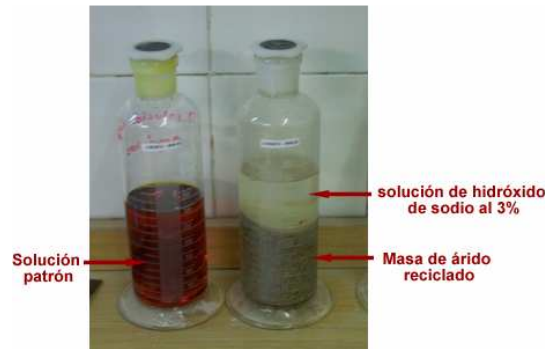
Figura Nº 2: Comparación de la mezcla de (RCD) sumergido en hidróxido de sodio con una muestra patrón.
