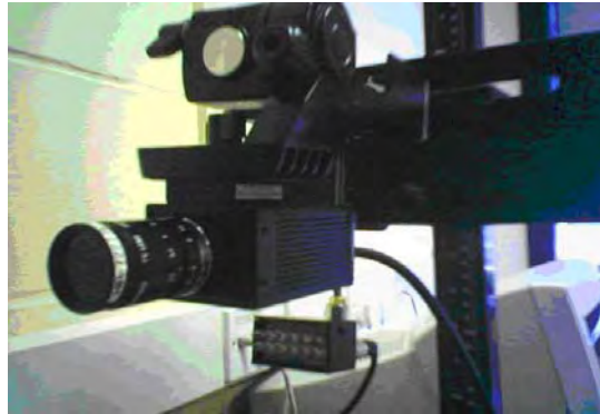
Figura 4-4 Vista del sistema de captura de imágenes de iris de la Bath University .
