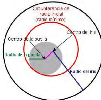
Figura 5-8 Esquema de la circunferencia de radio inicial para el proceso de extracción de características
