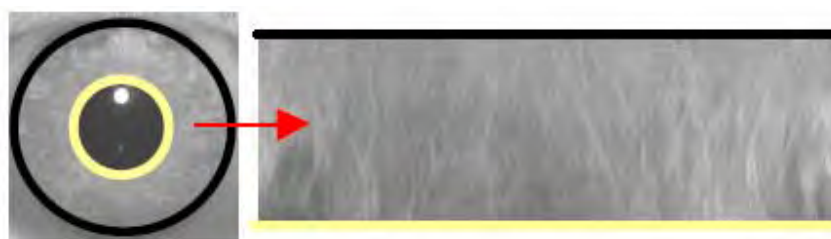
Figura 6-17 Representación rectangular del iris según el algoritmo “Tisse”.
