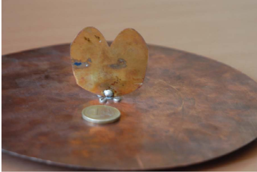
Figura 3.18: Fotografía del prototipo de antena del método híbrido comparada con una moneda de un euro centrada en el perfil
