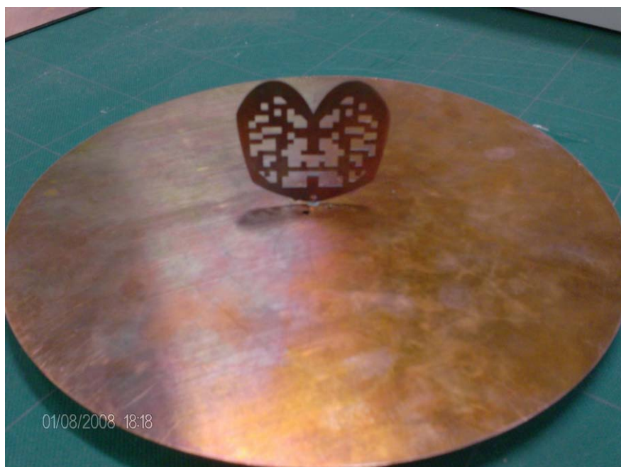
Figura 4.3: Fotografía del prototipo construido con la primera función de coste, incluyendo su plano de masa de 10 cm.
