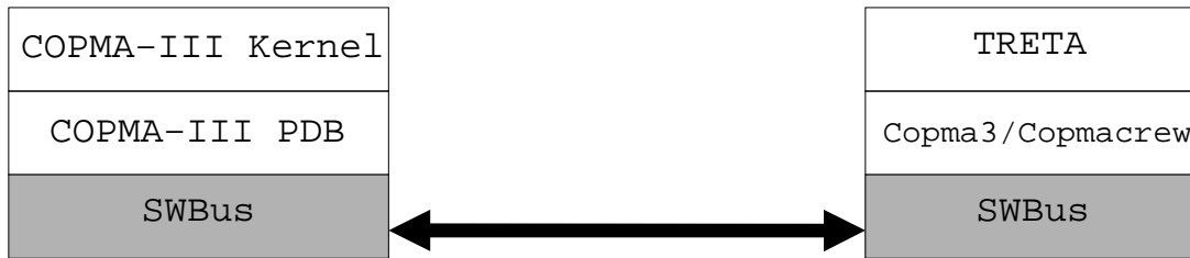
Figura 2.9: Configuración de la interfase de comunicaciones empleando la librería SWBus.
