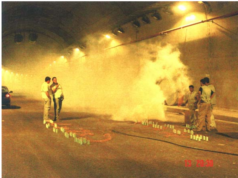
Imagen 5.3: Ensayo con humos en el túnel 2.
