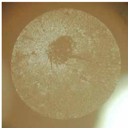
E17 - Diámetro de la fibra= 1.64 mm
