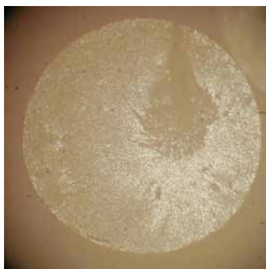
G30 - Diámetro de la fibra= 1.64 mm
