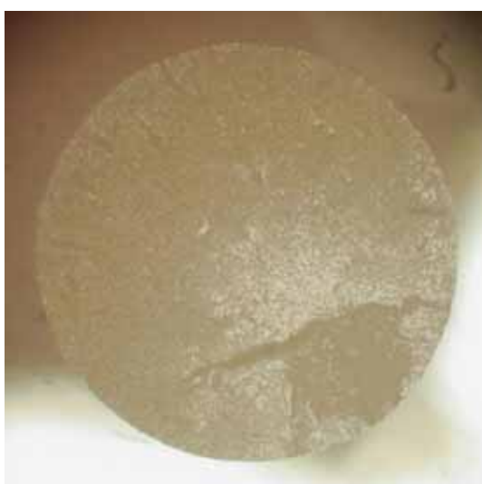
G65 - Diámetro de la fibra= 1.63 mm
