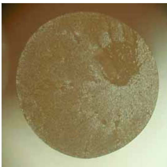
E30 - Diámetro de la fibra= 1.65 mm
