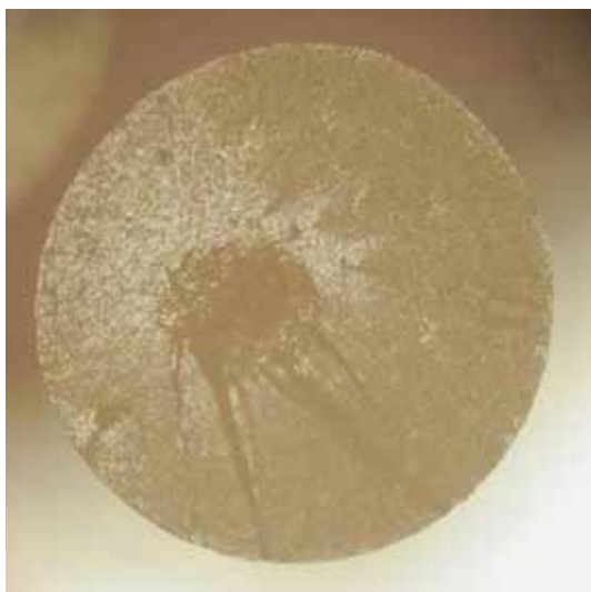
E58 - Diámetro de la fibra= 1.6 mm
