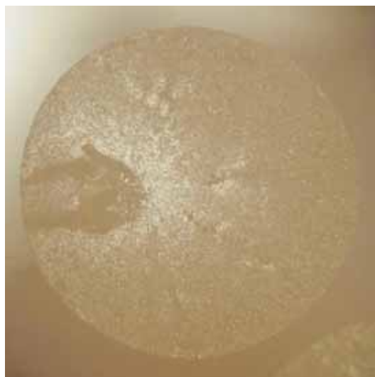
H26 - Diámetro de la fibra= 1.67 mm
