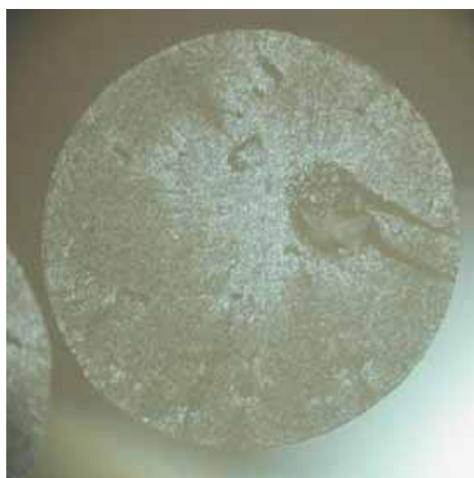
E35 - Diámetro de la fibra= 1.68 mm
