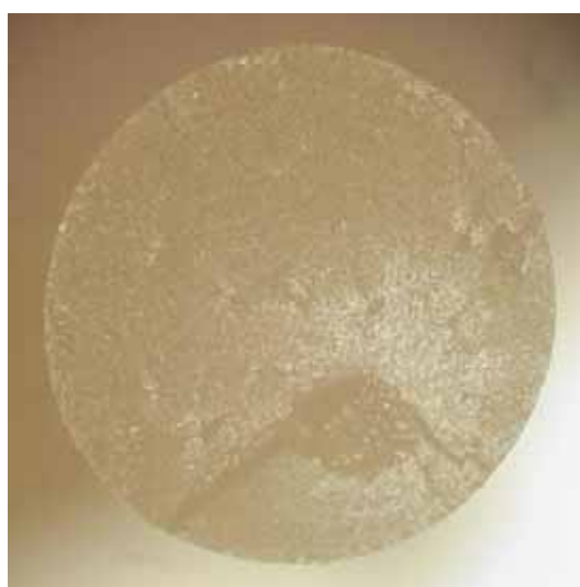
E37 - Diámetro de la fibra= 1.6 mm
