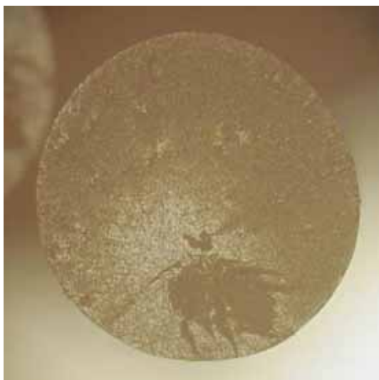
E52 - Diámetro de la fibra= 1.58 mm
