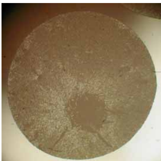
F63 - Diámetro de la fibra= 1.69 mm
