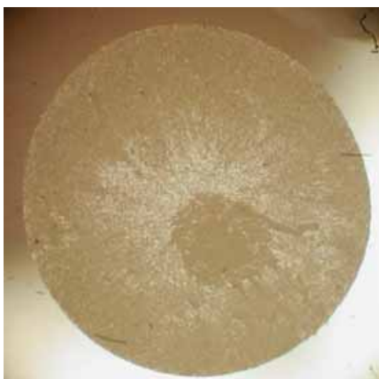
F57 - Diámetro de la fibra= 1.7 mm
