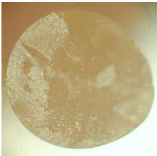
E16 - Diámetro de la fibra= 1.71 mm
