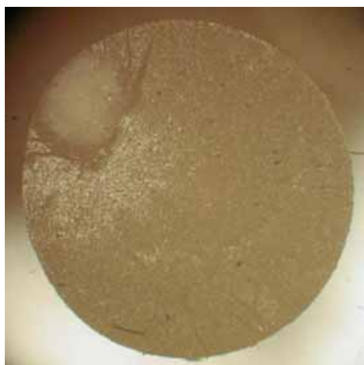
F18 - Diámetro de la fibra= 1.7 mm
