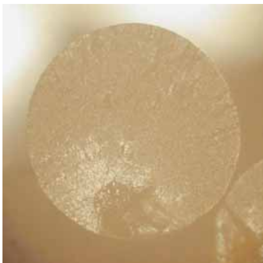
H3 - Diámetro de la fibra= 1.61 mm
