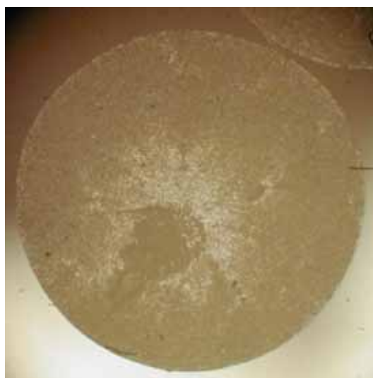
F28 - Diámetro de la fibra= 1.7 mm
