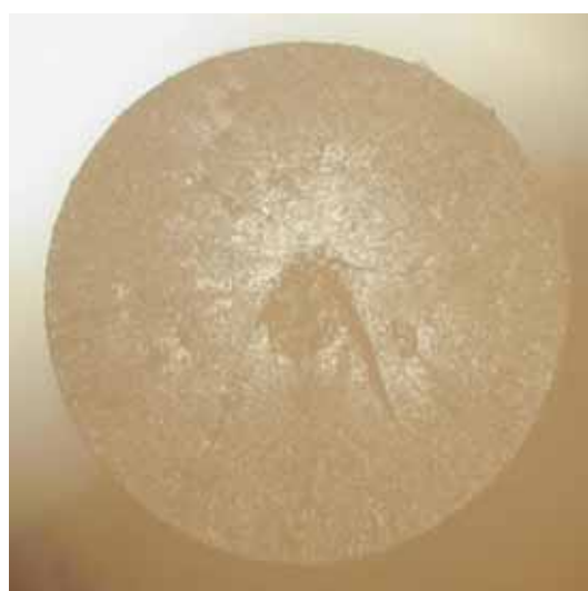
H48 - Diámetro de la fibra= 1.65 mm
