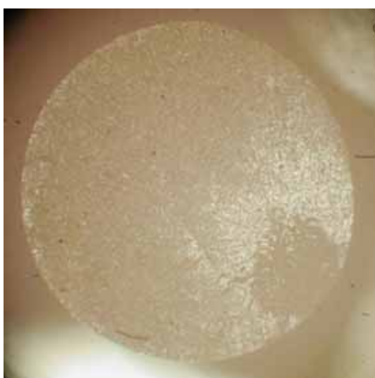
G29 - Diámetro de la fibra= 1.67 mm
