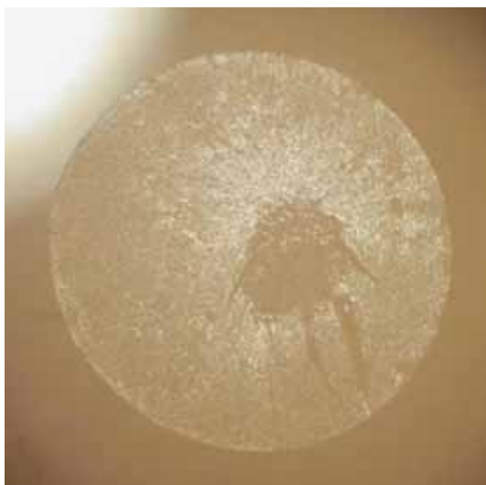
H1 - Diámetro de la fibra= 1.61 mm
