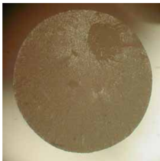
F58 - Diámetro de la fibra= 1.62 mm
