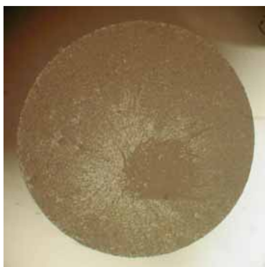
F66 - Diámetro de la fibra= 1.63 mm
