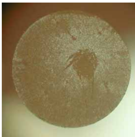
E31 - Diámetro de la fibra= 1.66 mm
