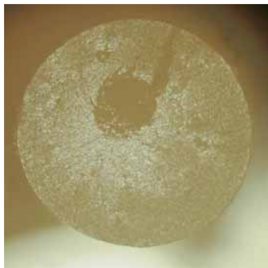
E2 - Diámetro de la fibra= 1.63 mm
