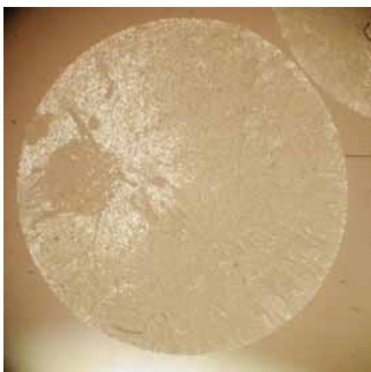
G35 - Diámetro de la fibra= 1.67 mm
