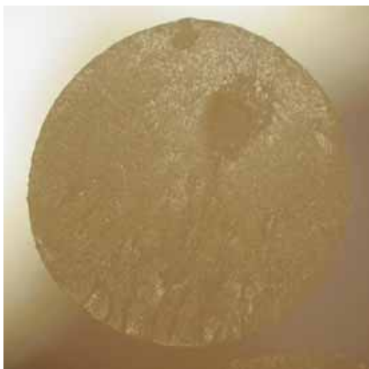
H21 - Diámetro de la fibra= 1.68 mm
