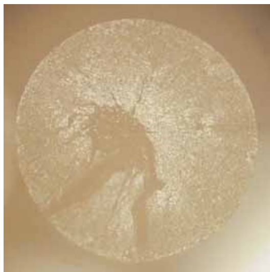
E57 - Diámetro de la fibra= 1.61 mm
