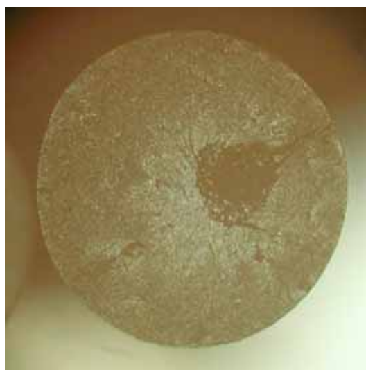
E13 - Diámetro de la fibra= 1.62 mm
