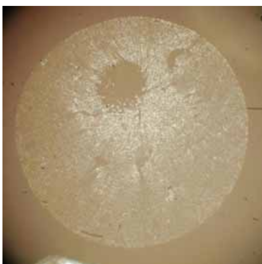
G11 - Diámetro de la fibra= 1.64 mm
