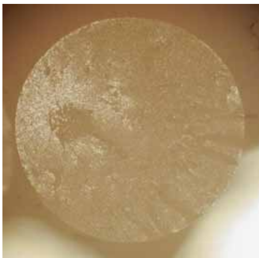
F7 - Diámetro de la fibra= 1.63 mm
