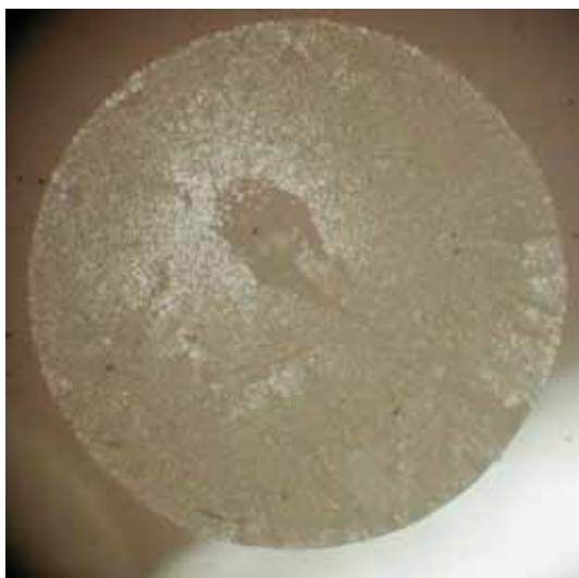
F1 - Diámetro de la fibra= 1.69 mm
