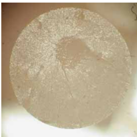
G63 - Diámetro de la fibra= 1.66 mm
