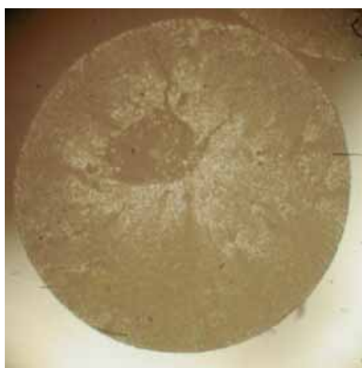
F30 - Diámetro de la fibra= 1.68 mm
