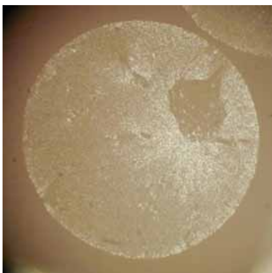
G9 - Diámetro de la fibra= 1.64 mm
