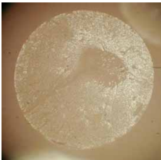
G43 - Diámetro de la fibra= 1.65 mm
