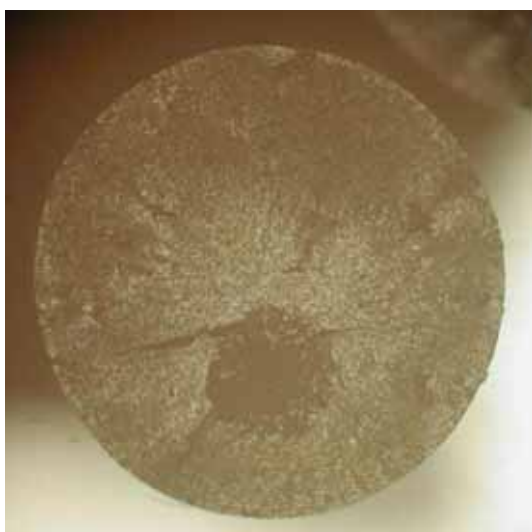
F39 - Diámetro de la fibra= 1.63 mm
