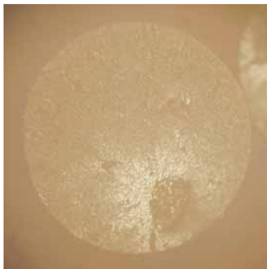
H16 - Diámetro de la fibra= 1.66 mm
