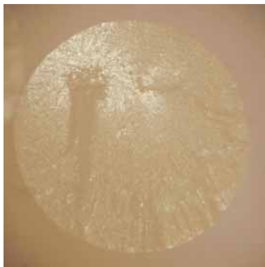
H32 - Diámetro de la fibra= 1.64 mm
