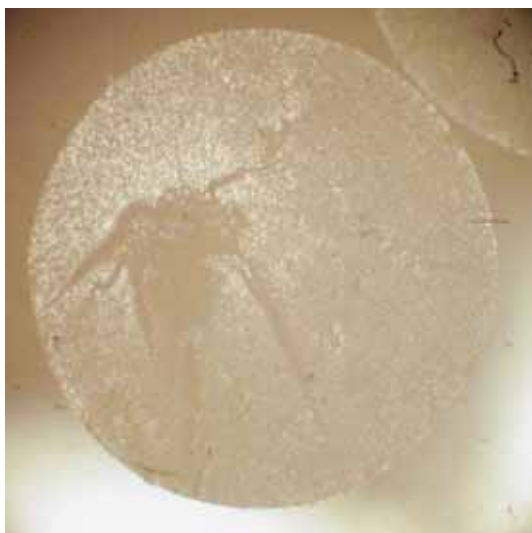
G33 - Diámetro de la fibra= 1.67 mm
