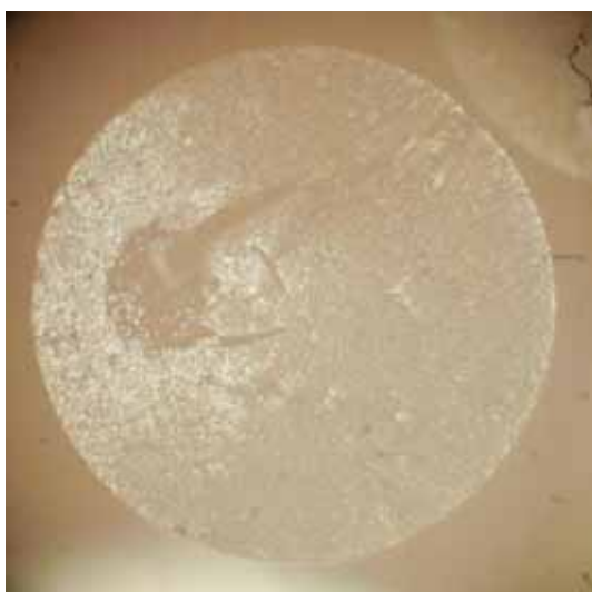
G45 - Diámetro de la fibra= 1.66 mm
