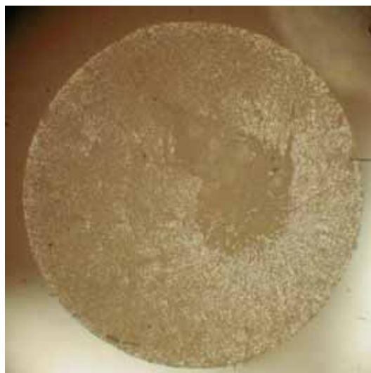
F38 - Diámetro de la fibra= 1.69 mm
