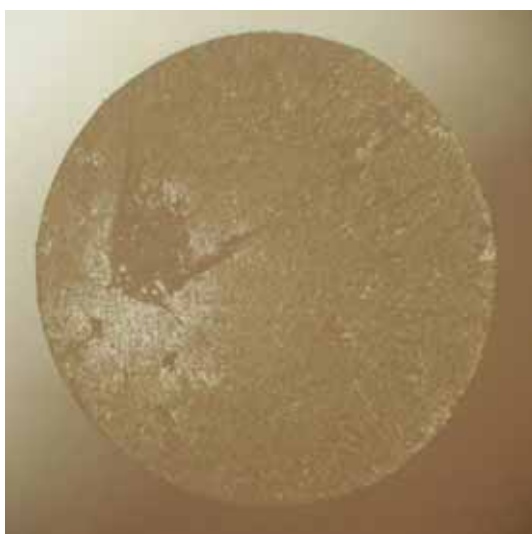
H23 - Diámetro de la fibra= 1.63 mm
