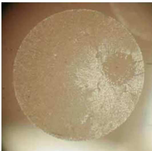
G61 - Diámetro de la fibra= 1.63 mm
