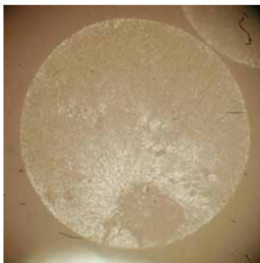
G40 - Diámetro de la fibra= 1.65 mm
