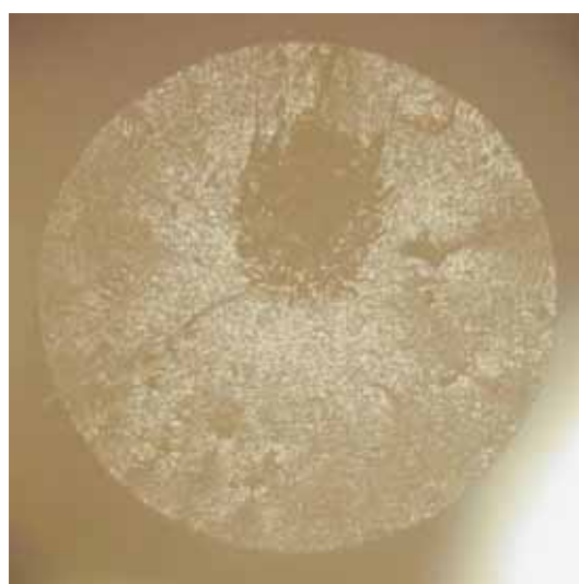
E43 - Diámetro de la fibra= 1.6 mm
