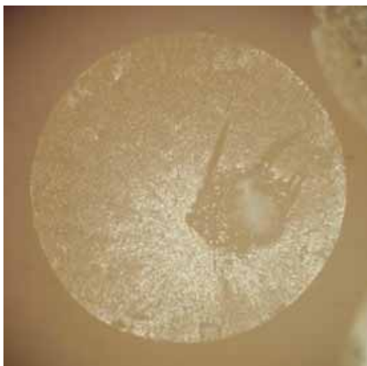
G1 - Diámetro de la fibra= 1.6 mm
