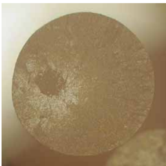
H41 - Diámetro de la fibra= 1.63 mm
