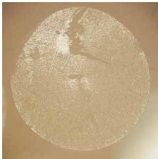
E53 - Diámetro de la fibra= 1.62 mm
