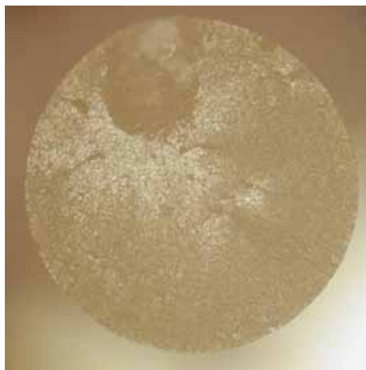
E59 - Diámetro de la fibra= 1.64 mm
