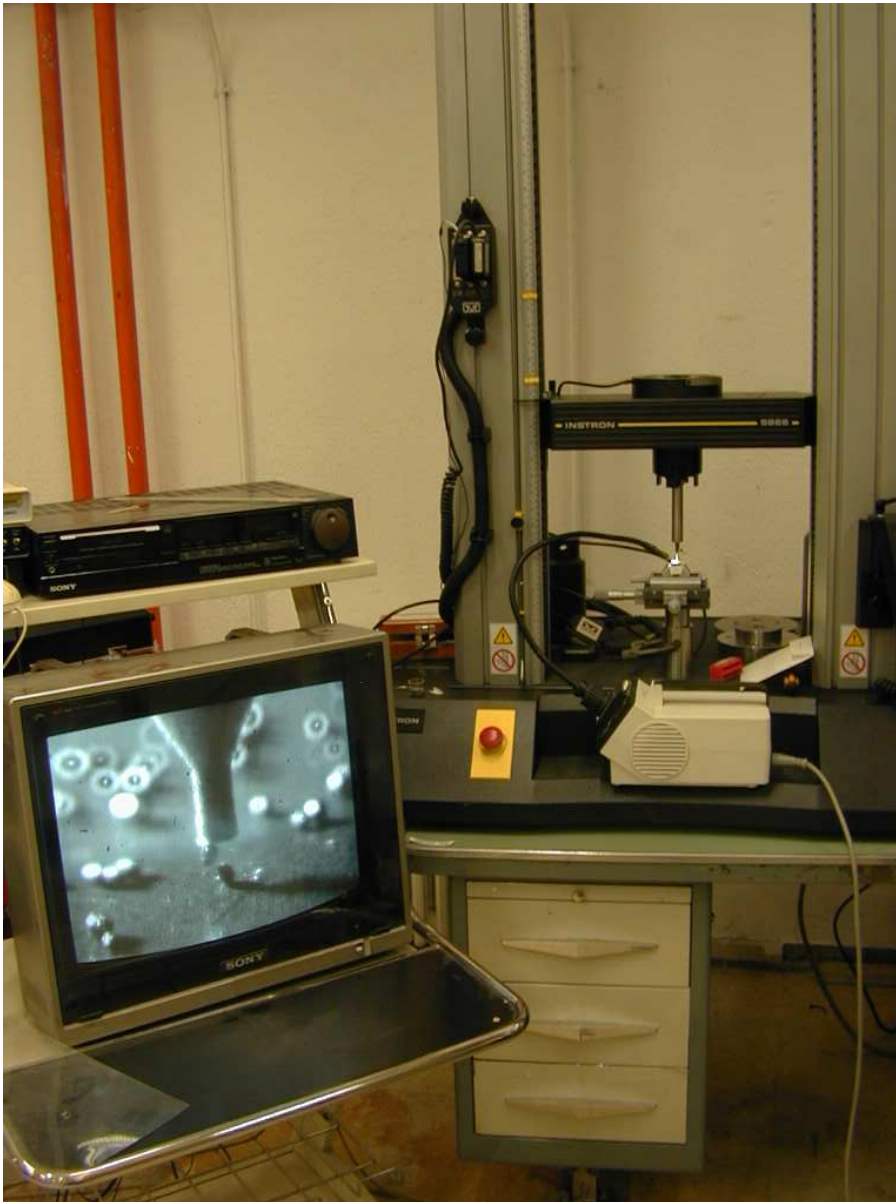
Figura 6.3: Dispositivo para realizar los ensayos de compresión diametral de las esferas de WC
