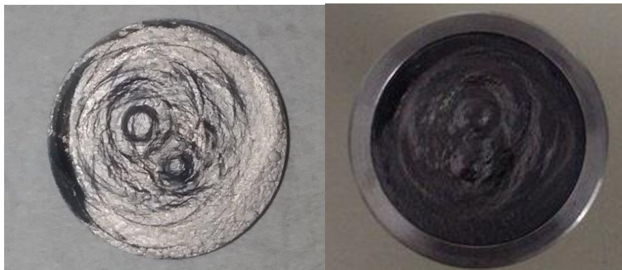
Figura 16. Blanco de grafito pirolítico después de la ablación.
