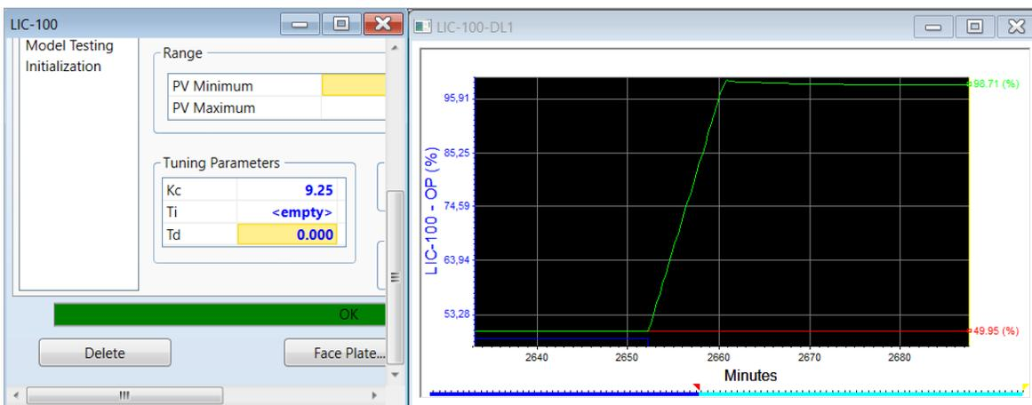
Figura 5.7. Controlador de nivel fuera de control.
