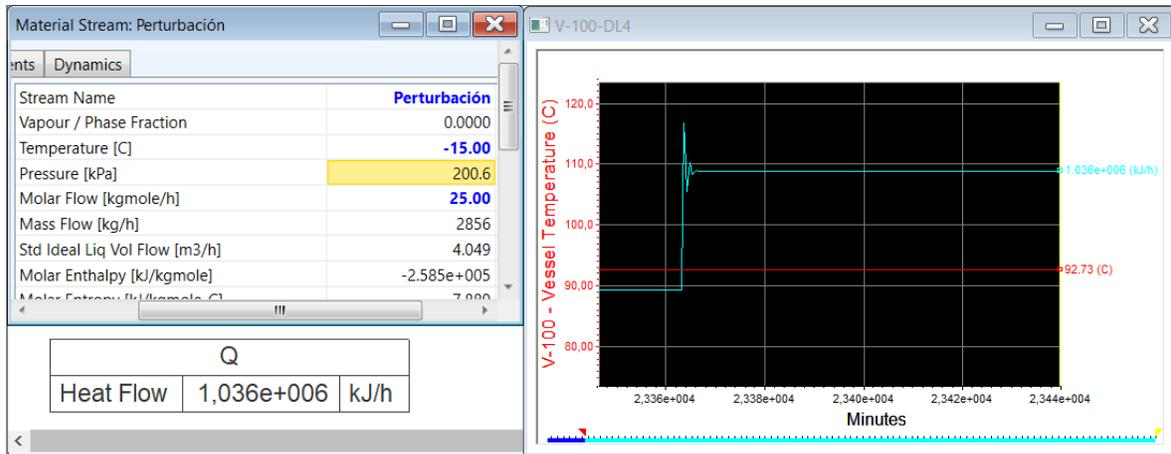
Figura 5.20. Respuesta del controlador a frente a una temperatura baja.
