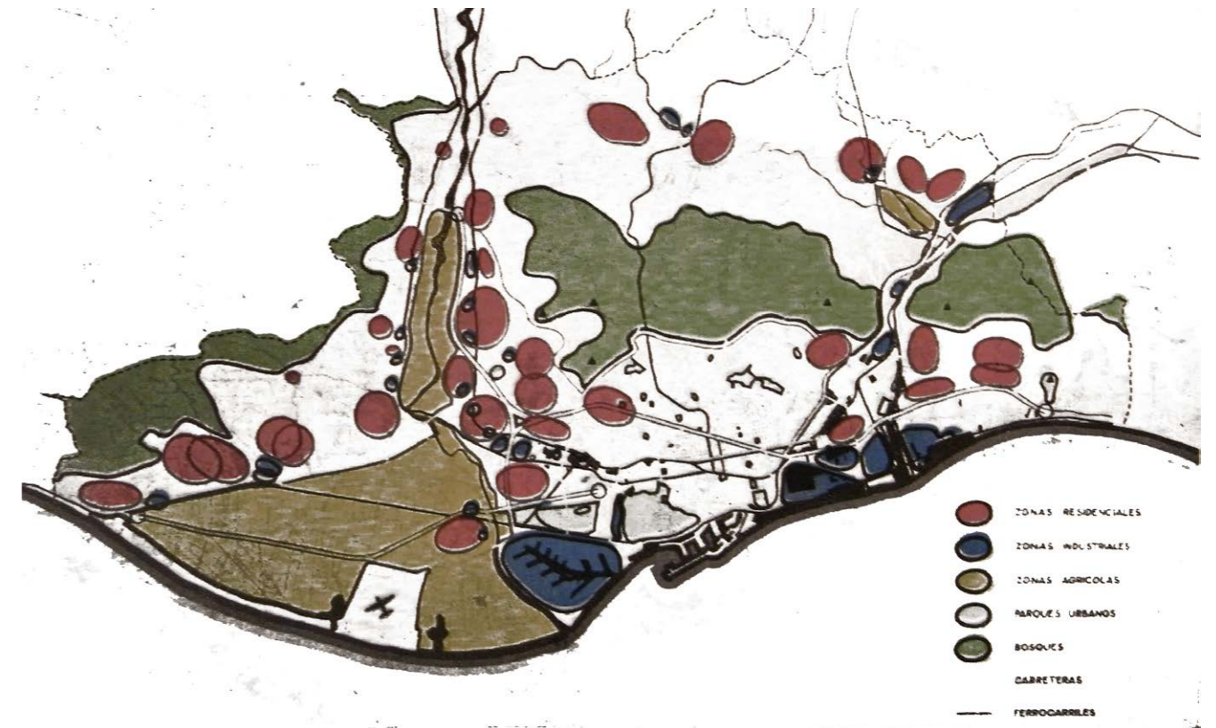
FIG.2.35 Zonificación, Tanteo Inicial. Plan de ordenación de Barcelona y su zona de influencia.1954. Autor: Comisión Superior de Ordenación Provincial.
