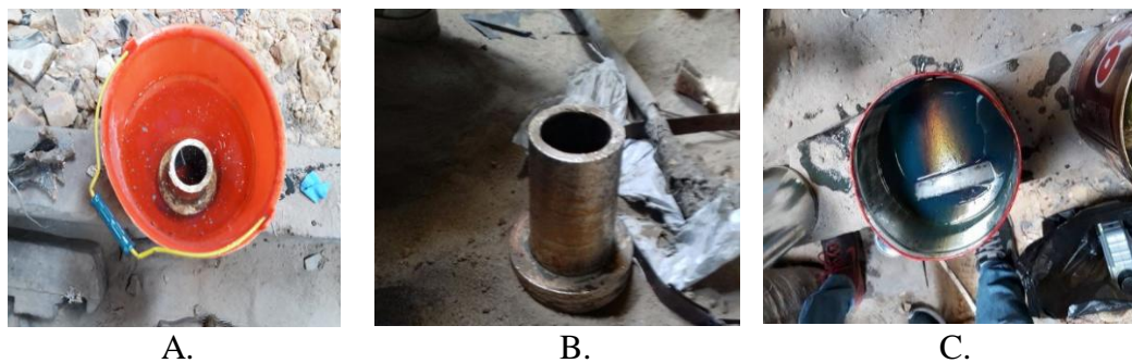
Gambar 9. (A) Media pendinginan air sumur, (B) Media pendinginan udara suhu ruangan, (C) Media pendinginan oli SAE 40
