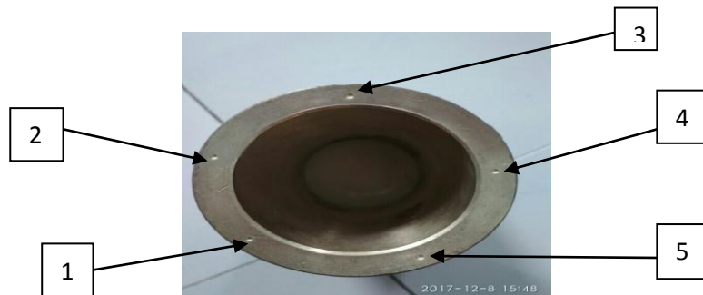
Gambar 11. Titik pengujian kekerasan
