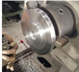
Gambar 19 Pembubutan Permukaan Pola
