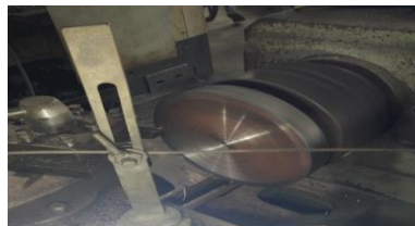
Gambar 17 Pembubutan Permukaan Pola Atas
