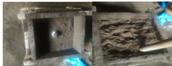
Gambar 9 Penuangan Pasir dan Penumbukan Cetakan Bawah
