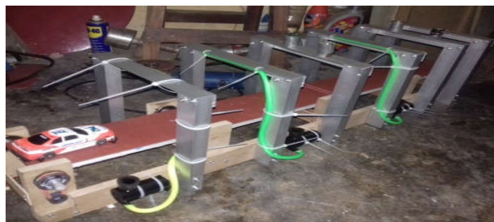
Gambar 4 pemasangan motor Wipper , motor dc dan selang kecil
