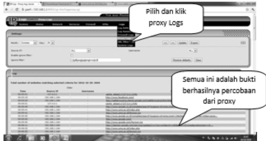
Gambar 16. Hasil bukti berhasil tersimpan di proxy logs
