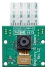
Gambar 4. Bentuk fisik modul kamera Raspberry Pi.
