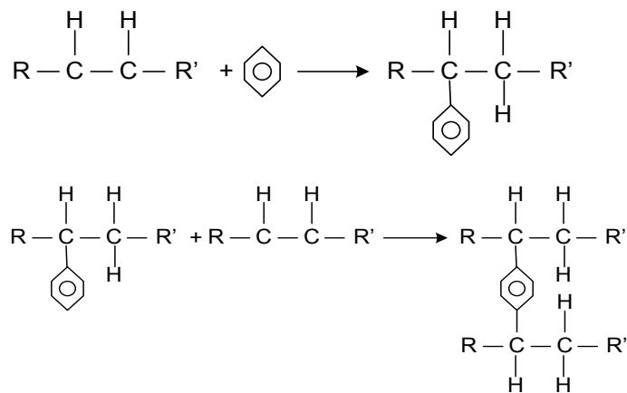
Pembuatan dodekilbenzen ini dengan proses DETAL, dimana berlangsung dalam reaktor *fixedbed*, pada suhu  $150^{\circ}C$  dan tekanan 15 atm. Dalam reaksi ini menggunakan katalis silika alumina. Reaksi ini menghasilkan produk utama dodekilbenzen dan produk samping didodekilbenzen.
