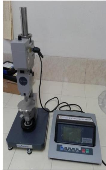
**Gambar 7.** Alat Uji Kekerasan
