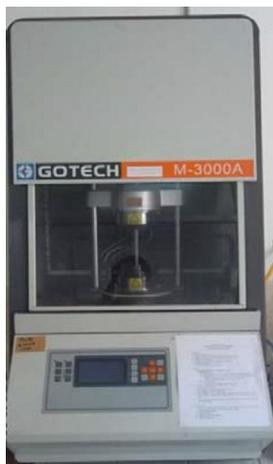
**Gambar 4.** Mesin *Rheometer*
