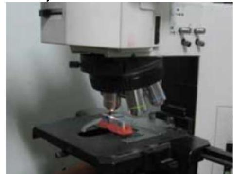
**Gambar 12.** *Alat uji stuktur mikro*
