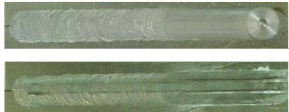
**Gambar 14.** Hasil pengelasan dengan *depth plunge* 1,9 mm
