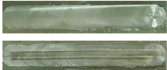
**Gambar 15.** Hasil pengelasan dengan *depth plunge* 2,9 mm
