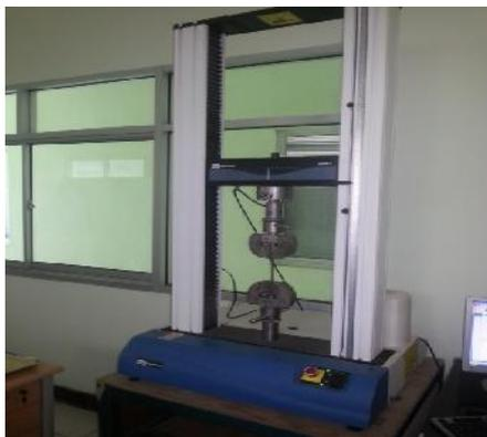
**Gambar 9.** *Mesin Uji Tarik*
