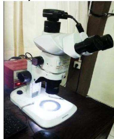
**Gambar 11.** *Alat uji struktur makro*
