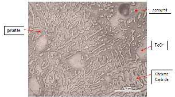
Gambar 12. Struktur Mikro Baja SKD 11 Tanpa Mengalami Perlakuan Panas Pembesaran 500X
