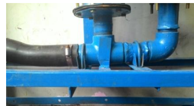
Gambar 5 : Badan pompa hidram
