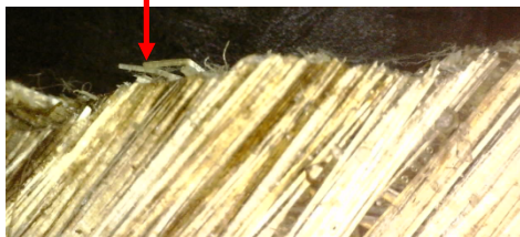
Gambar 27. Gambar patahan spesimen pengujian tarik pada suhu 29 0 C
