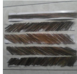
Gambar 17. Susunan serat untuk pengujian bending
